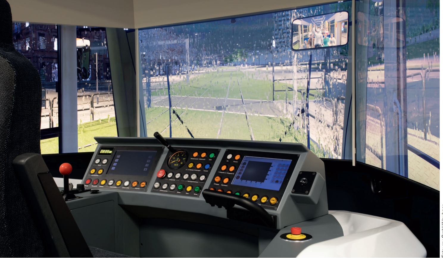
Abb. 1: In den Kabinensimulatoren des rnv „FahrSim“ lassen sich nicht nur alle erdenklichen Situationen auf realen Strecken, sondern auch unterschiedliche Witterungsverhältnisse simulieren.
